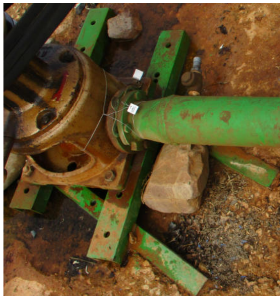
Fig. 4.17. Precintado de bancada.
